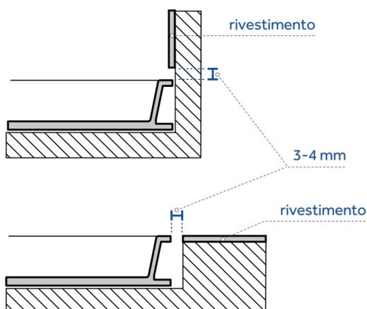
Alloggiare il piatto doccia tenendo conto dello spessore del rivestimento a parete (o al suolo in caso di installazione filo pavimento) e lasciando uno spazio di 3-4 mm.
